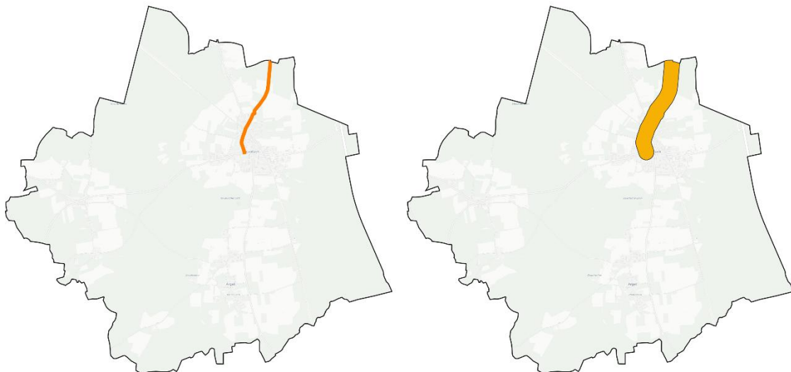
Abbildung 36: Lage von Abwasserkanälen größer DN 800 (links) und potenzielle Betrachtungs- und Einzugsgebiete für die Nutzung von Abwasserwärme (rechts)
